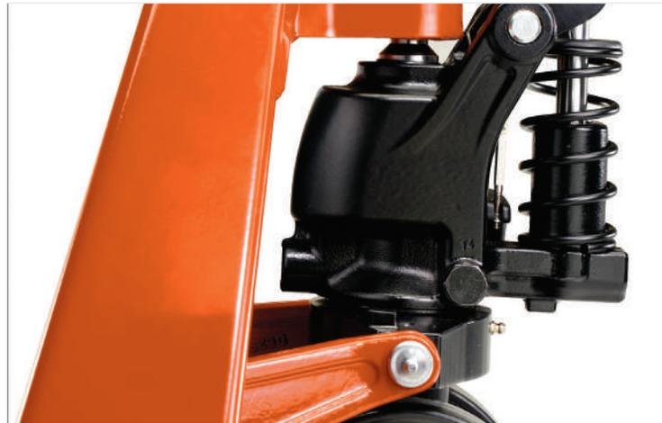
Stabil und einstellbar: Ventilstange und zwei Kugellager.
